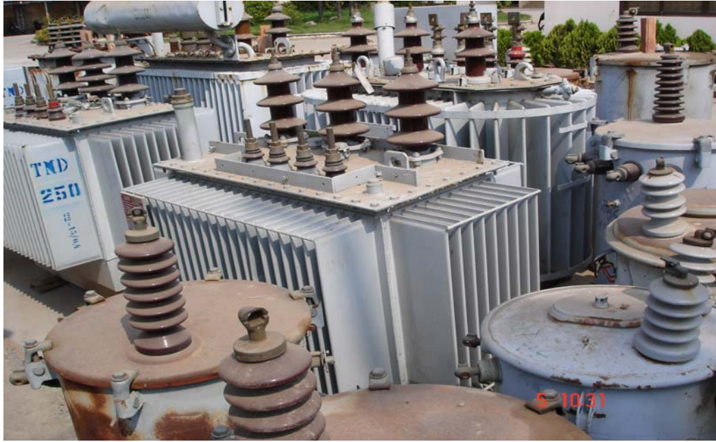
Hình 2.3. Máy biến thế được lưu giữ ngoài trời tại một chi nhánh điện lực
